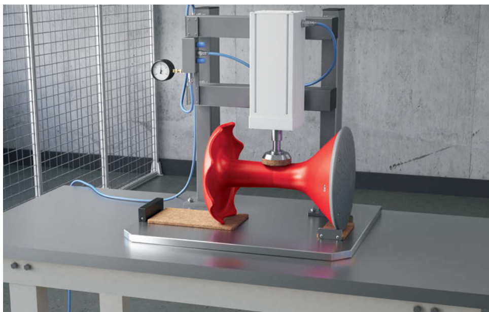
Der Hokki in der Festigkeitsprüfung nach VS-Vorgabe
