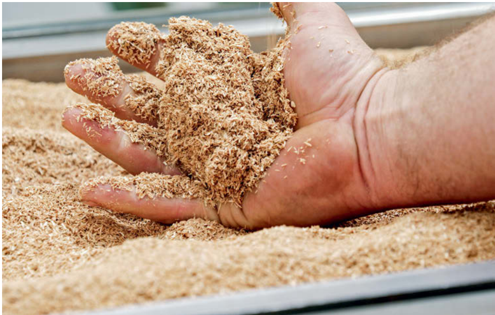
Sägespäne aus Resthölzern, dem Rohstoff für die LIGNOdur-Platte
